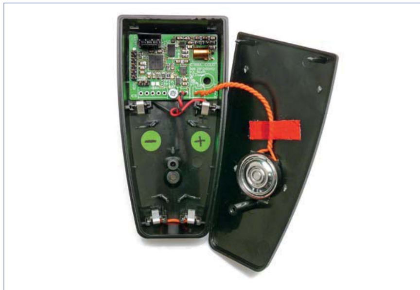
Bild 7. Dies ist der Prototyp des Autors. Der Lautsprechermagnet beeinflusst die Messungen des Magnetometers. Der Effekt wird in der Software kompensiert.
